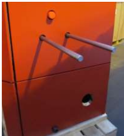
Slika.1 Manipulisanje kotlom pomoću nosača
